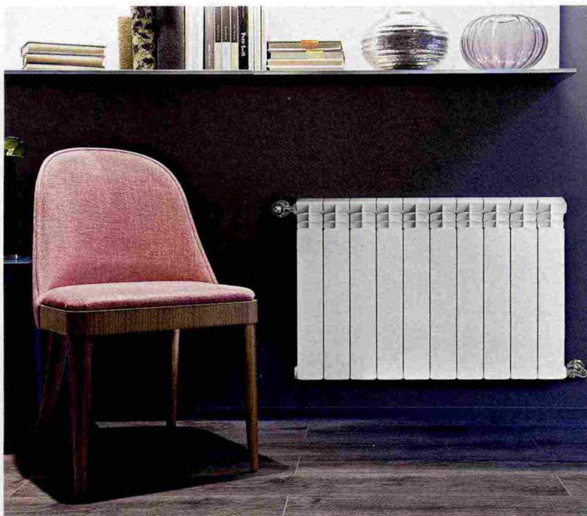
È realizzato in alluminio pressofuso ottenuto da materiale di riciclo, nel rispetto dell'ambiente, **Esclusivo D3 di Fondital** ([www.fondital.it](http://www.fondital.it)). È composto da elementi modulari (L 8 x P 9,7 x H 40,7/85,7 cm), in modo da adattarsi a diversi spazi e necessità di calore. **Ha bassa inerzia termica a vantaggio del risparmio energetico e del ridotto consumo di acqua.**
